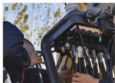
⑩手动操作，起车检查换装电磁比例阀后的效果
