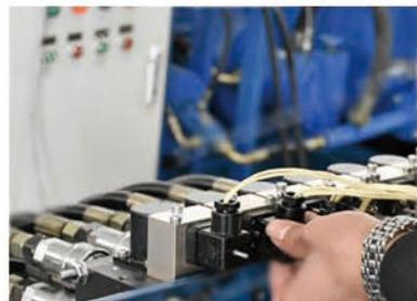
⑥安装：主进油口、主出油口、多路阀进出油口、溢油口转接螺母（B口进油 A口出油）
