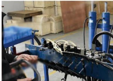
⑦将电磁阀安装到固定台架上，固定好
