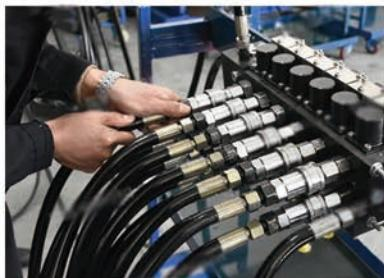
④遥控器无线遥控电池比例阀测试
