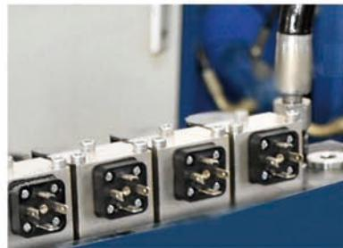
③接收器插头，连接电控插头（注意方向）
